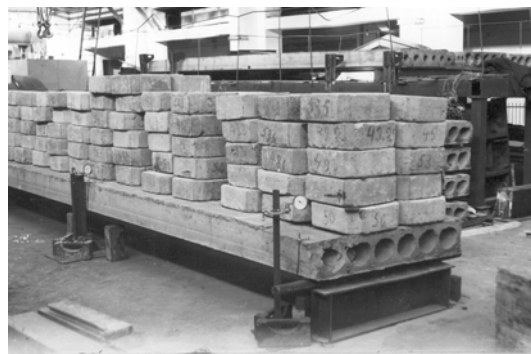
Рис.2. Испытания поризованной плиты перекрытия на прочность, жесткость и трещиностойкость.
